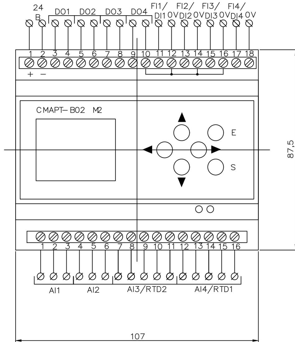
Прибор имеет четыре дискретных выхода (полная группа контактов); два или четыре аналоговых входа RTD (3-х проводная или 4-х проводная схема подключения); два или четыре аналоговых входа для подключения датчика 0..20 мА (пассивного или активного); универсальный вход (частотный/дискретный) для подключения "сухой контакт" или активного датчика 0..20 мА.
